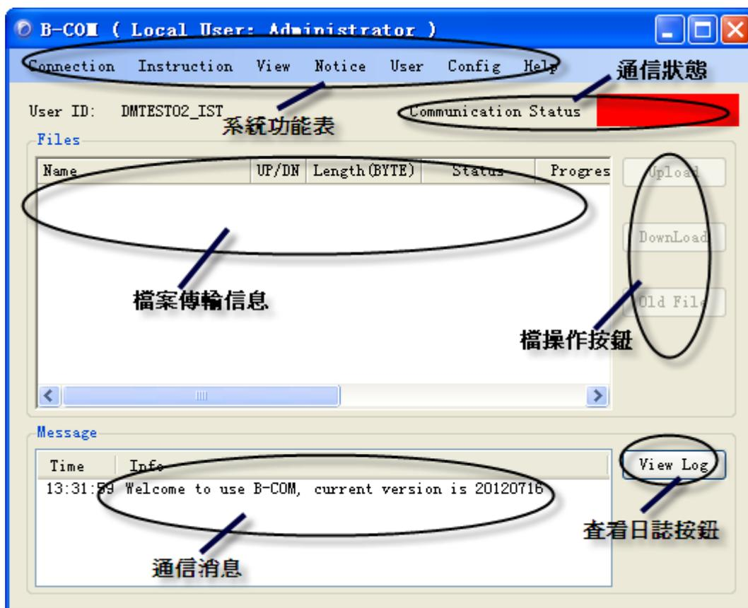
图24 B-COM 系統主介面
